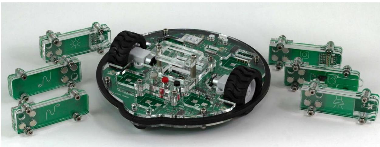
Рисунок 4 – Робоплатформа с набором датчиков
