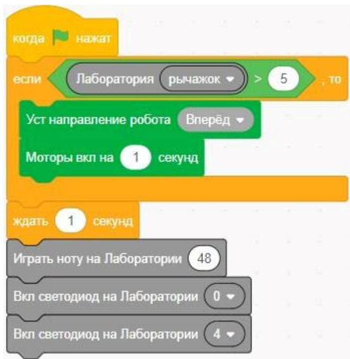
Описание работы программы: если рычажок лаборатории сдвинут на значение больше 5, то роботоплатформа проедет вперед, после этого из динамика Лаборатории прозвучит звук и загорятся светодиоды.
